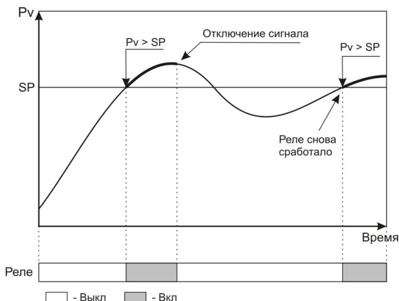
Рисунок 6 Иллюстрация использования режима оперативного (ручного) отключения реле.
