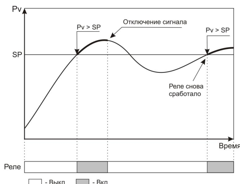
Рисунок 6 Иллюстрация использования режима оперативного (ручного) отключения реле.
