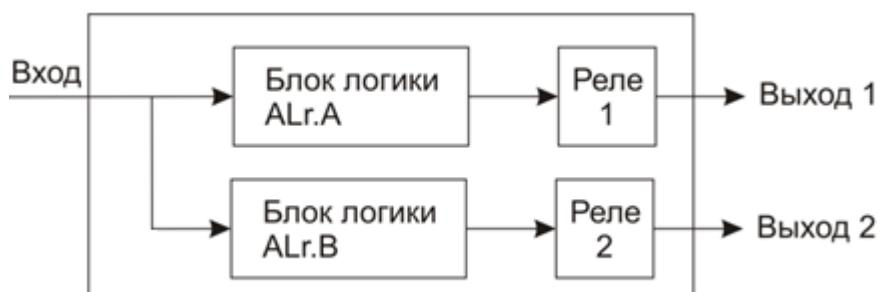
Рисунок 2 Логическая схема прибора
